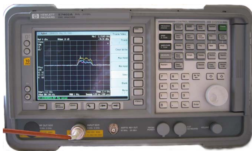
Figur 4.5. Med en spektrumanalysator uppmäts både styrka och frekvens på signalen, foto J Trulsson.
