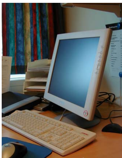
Figur 3.16. Skärmar som bygger på vätskekristallteknik ersätter katodstrålerörskärmarna.
