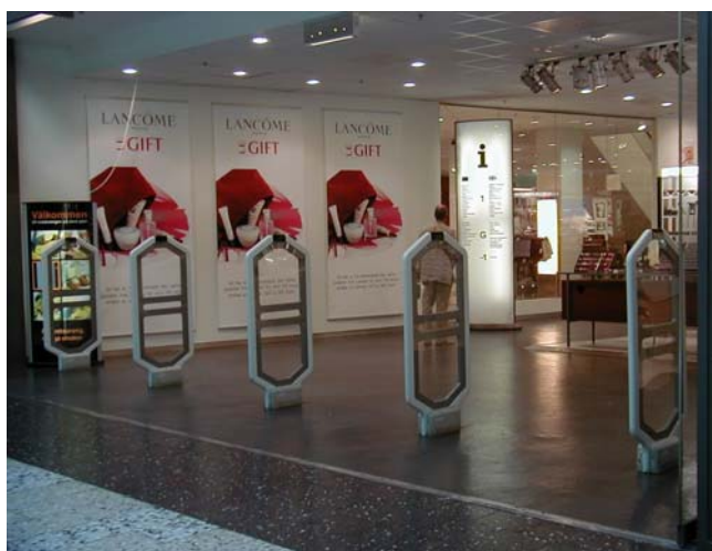
Figur 3.18. Stöldlarmbågar kan alstra fält vid olika frekvenser beroende på larmsystem, foto Svante Wijk.
