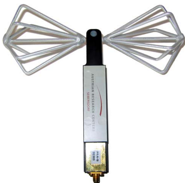
Figur 4.6. Bredbandig mätantenn för radiofrekventa fält, foto J Trulsson.
